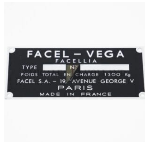
PLAQUE DU CONSTRUCTEUR (NUMÉRO DU CHASSIS 4 CYL)
