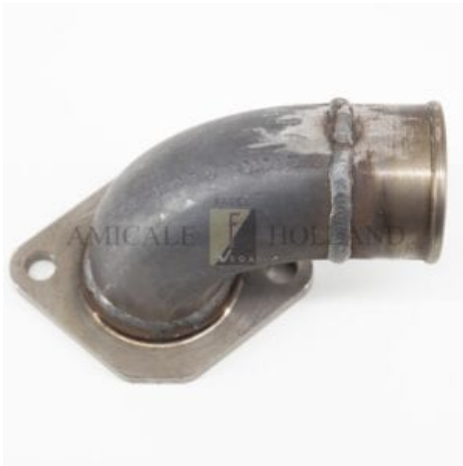
PIPE DE SORTIE D'EAU SUR POMPE À EAU HK/EXC
