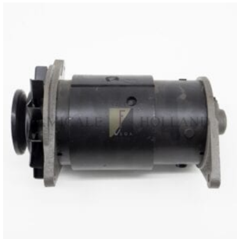
GÉNÉRATRICE (HK/EXC/FACEL II) REVISÉE (ÉCHANGE) 35A
